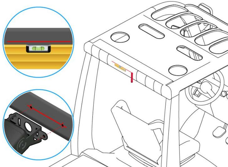
图 14: 水平仪标记及钻孔位置示意图
