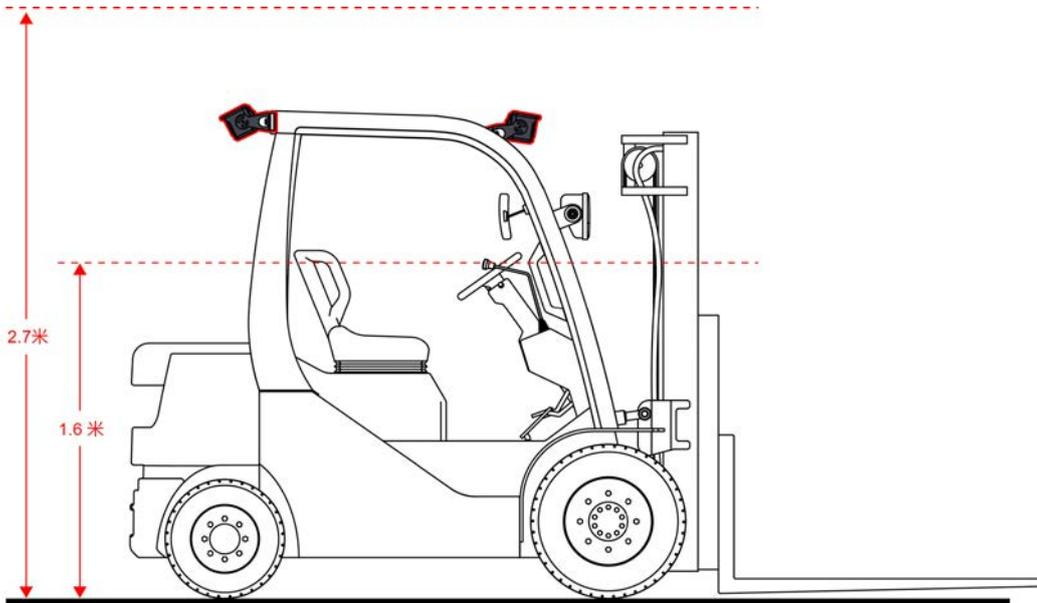
图 13: 前方与后方摄像头安装高度示意图
