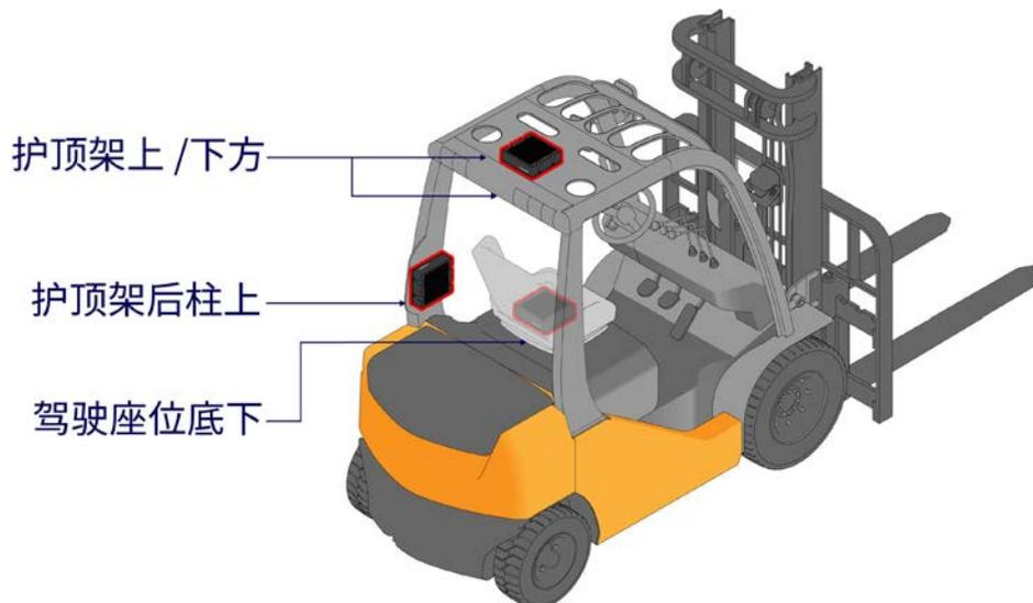
图 10: 建议安装位置示意图
