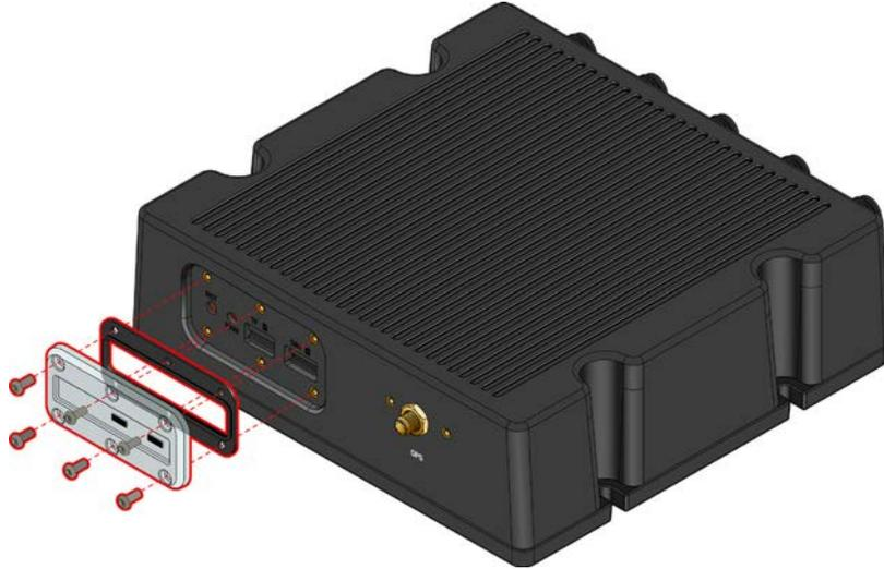
图 06: 安装前面板防水盖示意图
