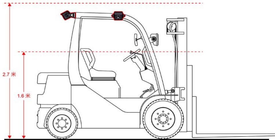
图 22: 前方与后方摄像头安装高度示意图
