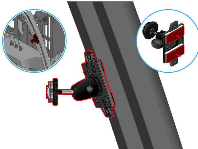
图 43: 使用磁铁及 3M 双面胶带安装 7 寸 CVBS 显示屏支架示意图
