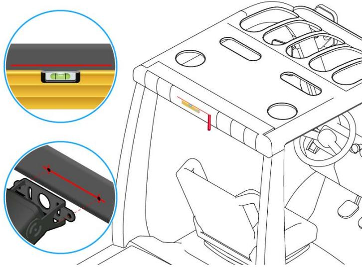
图 23: 水平仪标记及钻孔位置示意图
