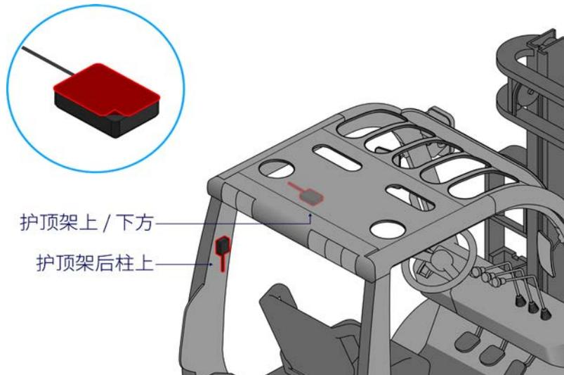
图 27: 天线安装示意图
