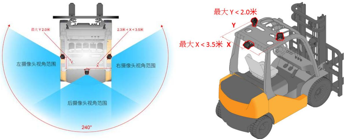
图 20: 情况二摄像头安装示意图
