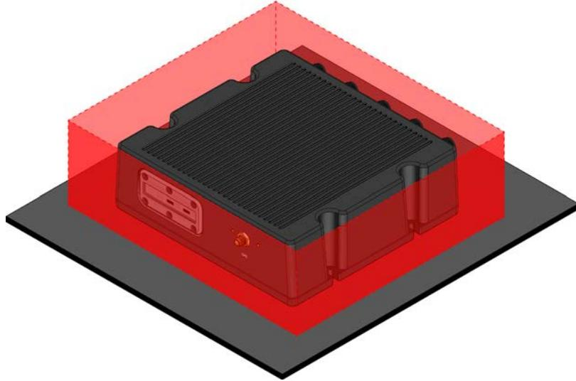
图 09: 主机安装所需空间示意图
