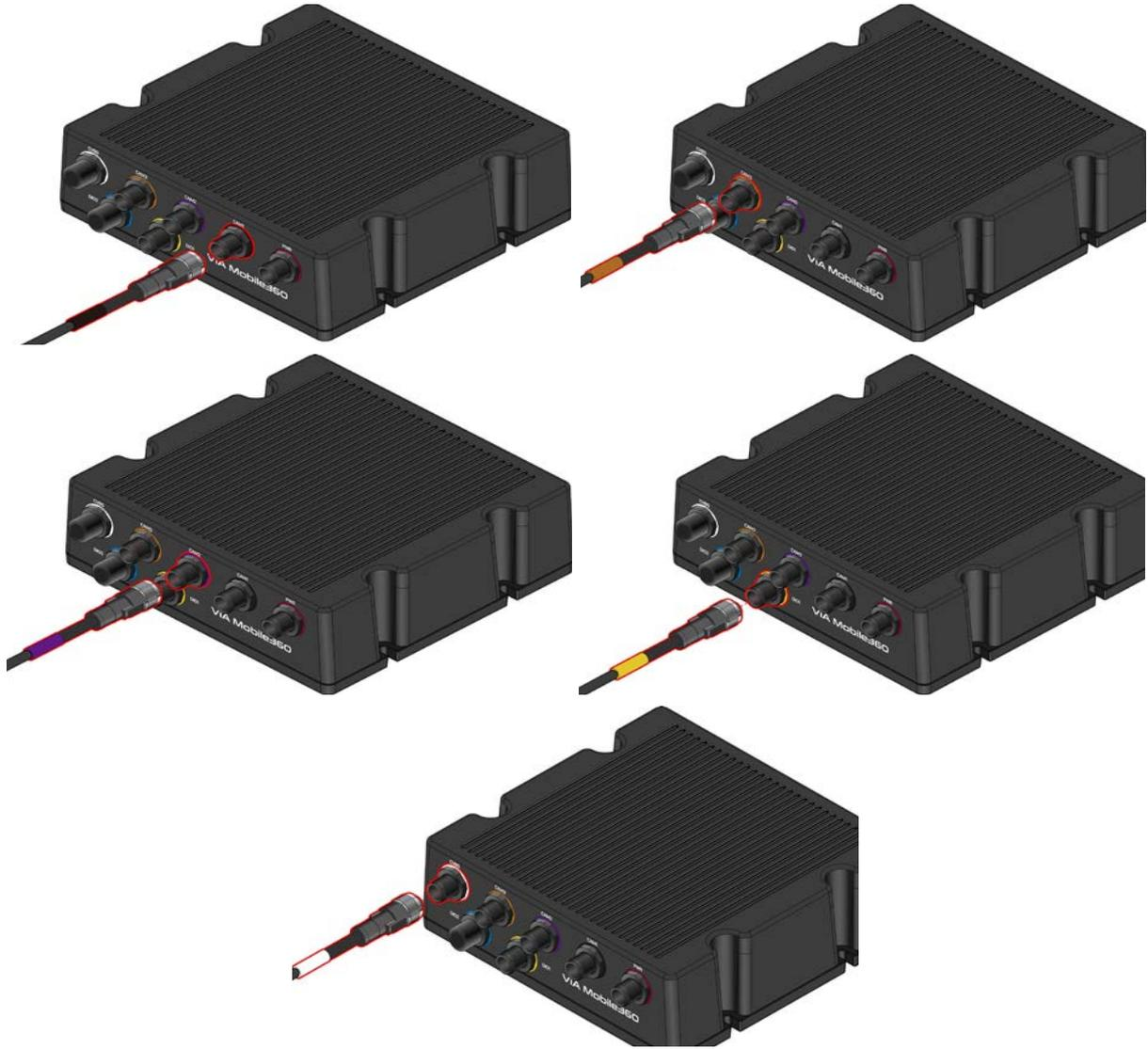
图 30: 后面板 I/O 连接
