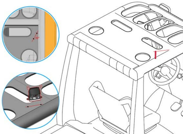
图 24: 标记旋转 30 度的两侧摄像头安装位置
