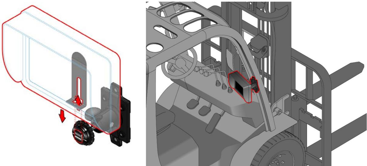
图 45: 7 寸 CVBS 显示屏安装示意图
