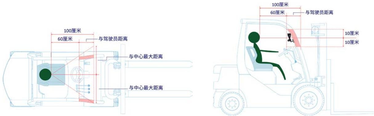
图 16: 驾驶摄像头安装位置建议示意图
