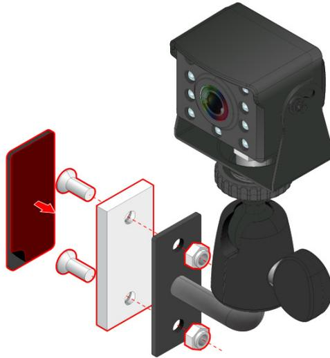
图 46: 安装磁铁及 3M 胶带于驾驶摄像头支架底部示意图
