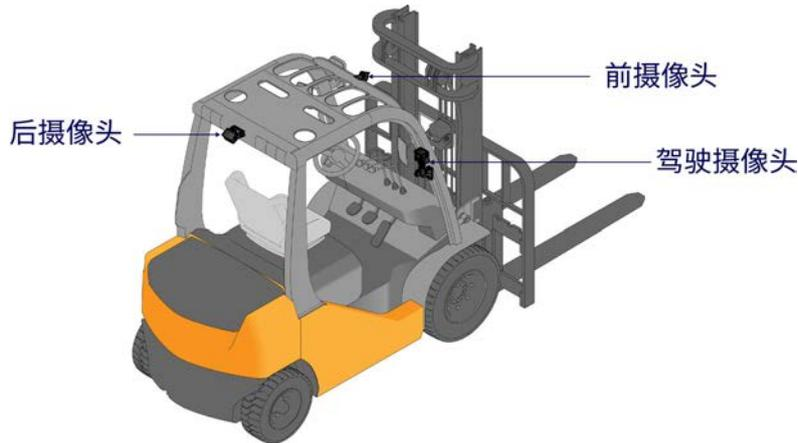
图 11: 摄像头安装位置示意图
