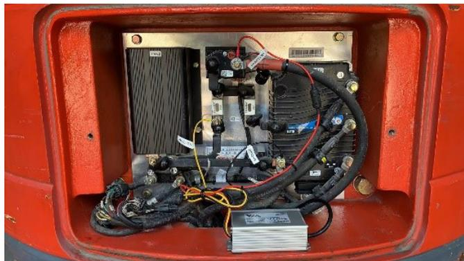
9. M12 至 M12 电源转接电缆的一端连接到 威盛 Mobile360 直流电源模块的电缆上，另一端连接到 威盛 Mobile360 叉车安全系统主机的红色电源（PWR）接头。
