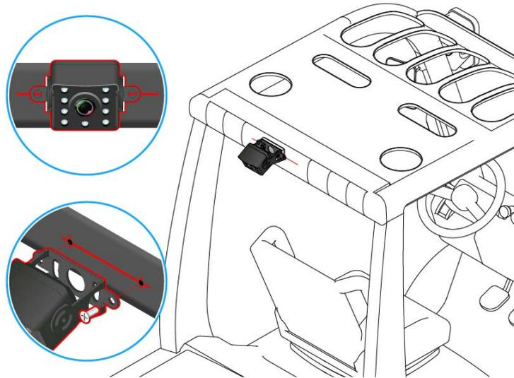
图 25: 使用膨胀螺丝安装前 / 后摄像头示意图
