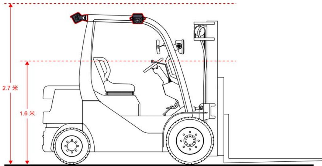
图 17: 两侧摄像头与后摄像头安装位置示意图
