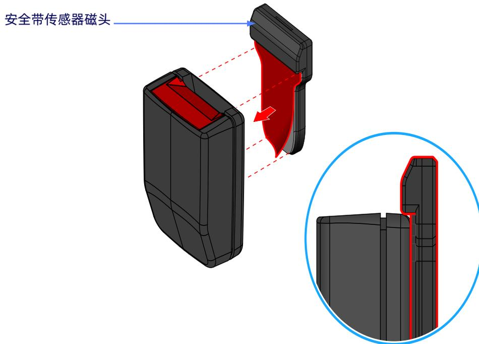
图 48: 安全带传感器安装
