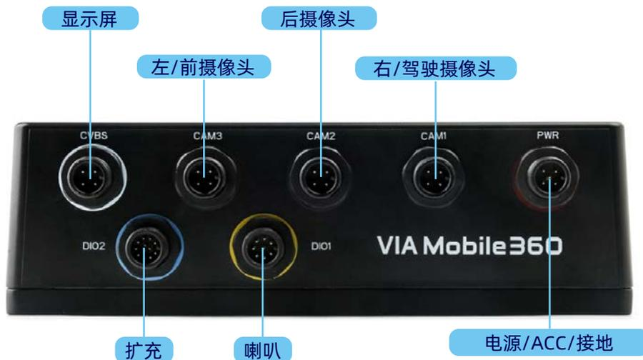
图 02: 后面板 I/O 排列示意图
