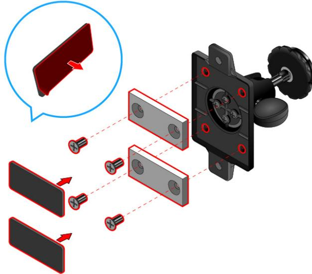
图 42: 7 寸 CVBS 显示屏支架安装示意图
