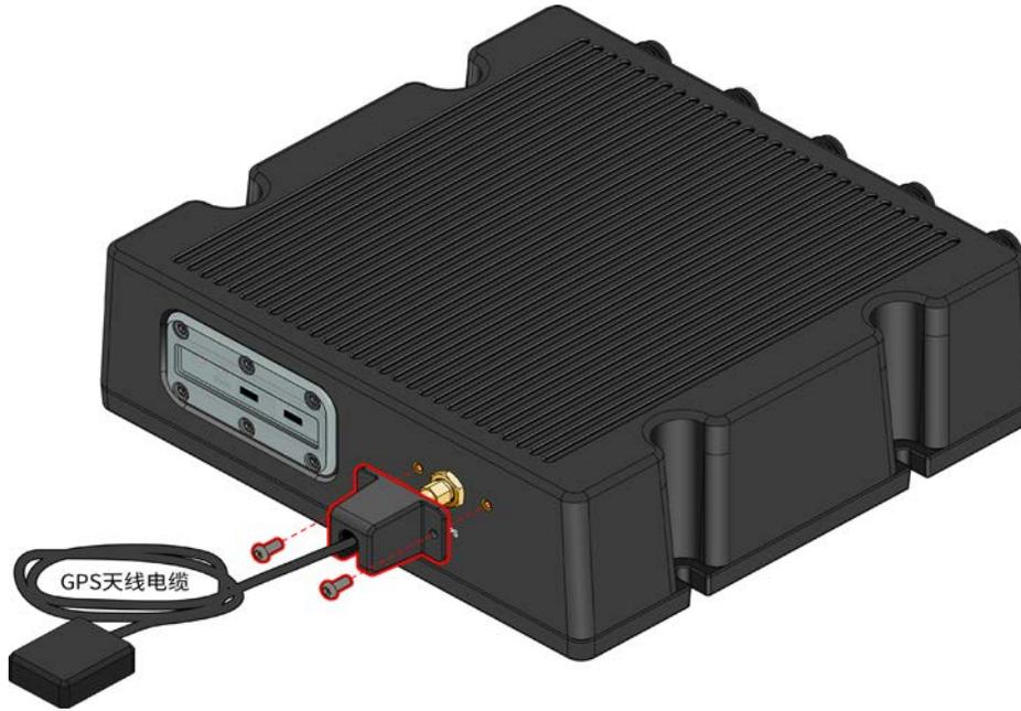
图 29: GPS 天线安装示意图
