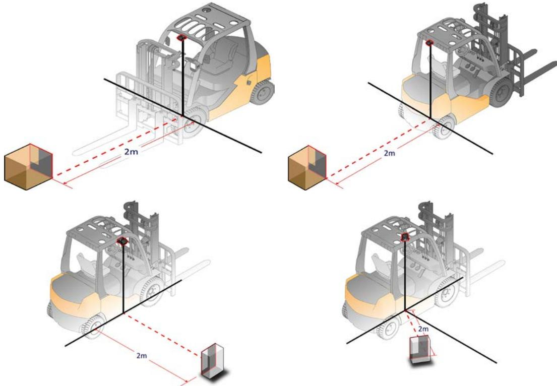
图 39: 摄像头 L 型校准图示摆放示意图
