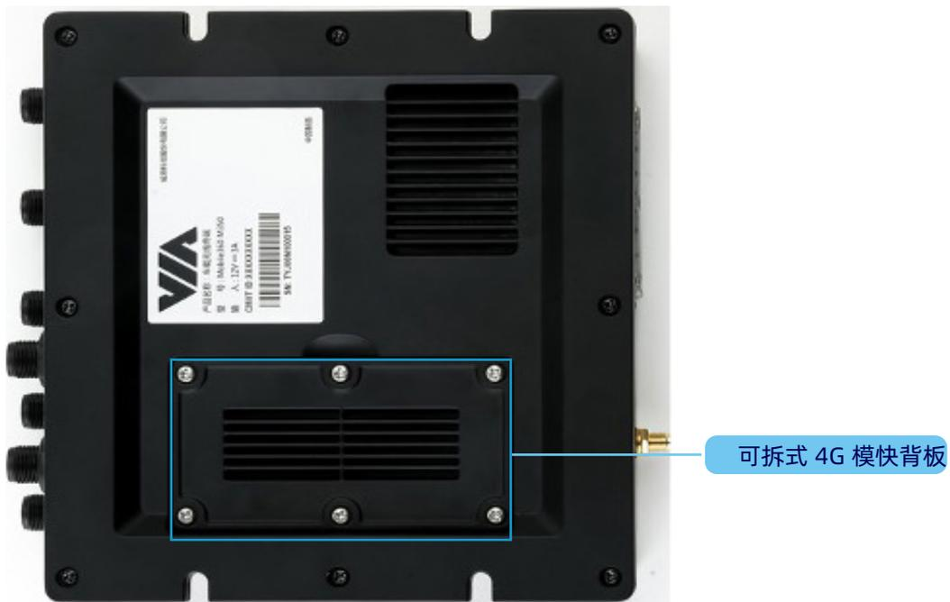
图 52: 4G LTE miniPCIe 模块隔间的位置
