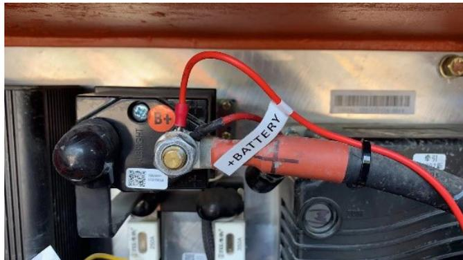
7. 接着寻找叉车上合适的位置安装 威盛 Mobile360 直流电源模块。请确认安装的位置能将电源模块的电缆连接至 威盛 Mobile360 叉车安全系统主机的红色电源 (PWR) 接头 (电缆长约 2.3 米长)。确认安装位置之后，用马克笔标记两侧螺丝孔的位置并钻孔。
