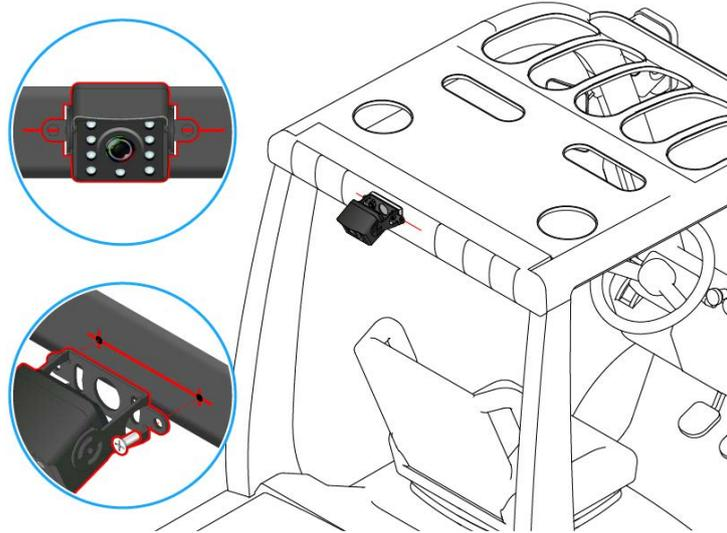
图 15: 使用膨胀螺丝安装前 / 后摄像头示意图
