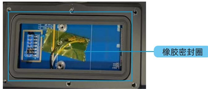
图 53: 取下橡胶密封盖
