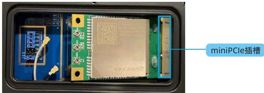
图 55: 插入 4G LTE miniPCIe 模块
