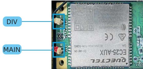
图 57: 将天线连接到 4G LTE miniPCle 模块
