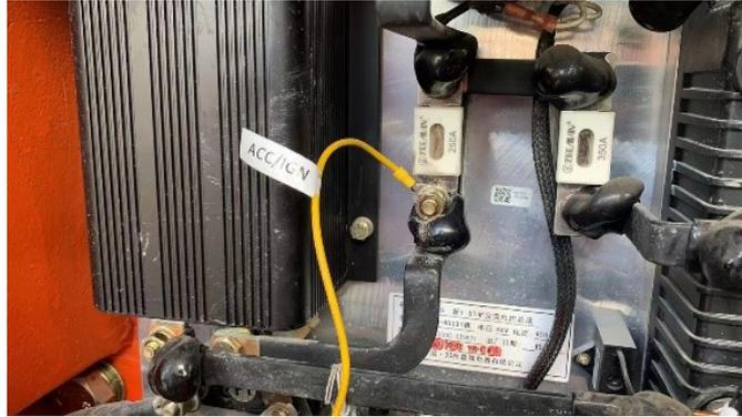
6. 松开步骤 4 找到的电池正级螺栓，将 威盛 Mobile360 直流电源模块上红色电缆末端的 Y 型接头置于螺栓下方，拧紧螺栓以固定电缆。将红色电缆和黑色电缆固定妥当之后，此时 威盛 Mobile360 直流电源模块电缆接头内部的绿色 LED 应会亮起，代表直流电源模块运作正常。
