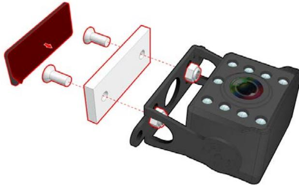
图 21: 安装磁铁及 3M 胶带于前 / 后摄像头支架底部示意图
