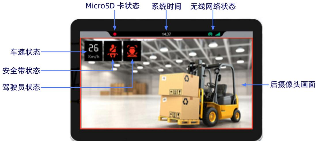
图 38: 7 寸 显示接口 (全屏相机视图)
