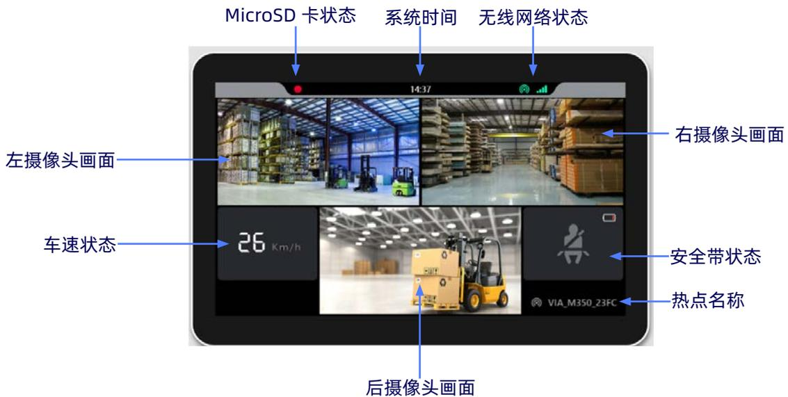
图 37: 7 寸 显示接口（如安装左右后置摄像头）
