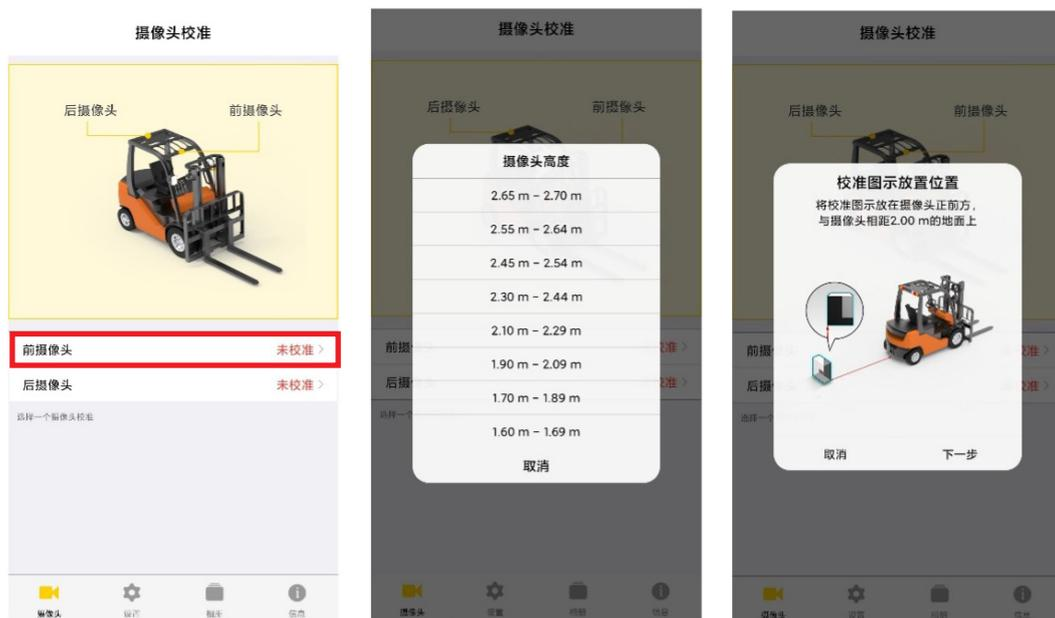
5. 调整摄像头角度，使校准画面上的十字准星与步骤 1 放置的 L 型黑色图案左下角对齐。若要调整摄像头角度，请松开摄像头支架两侧的螺丝，确认摄像头角度无误后再拧紧螺丝。
