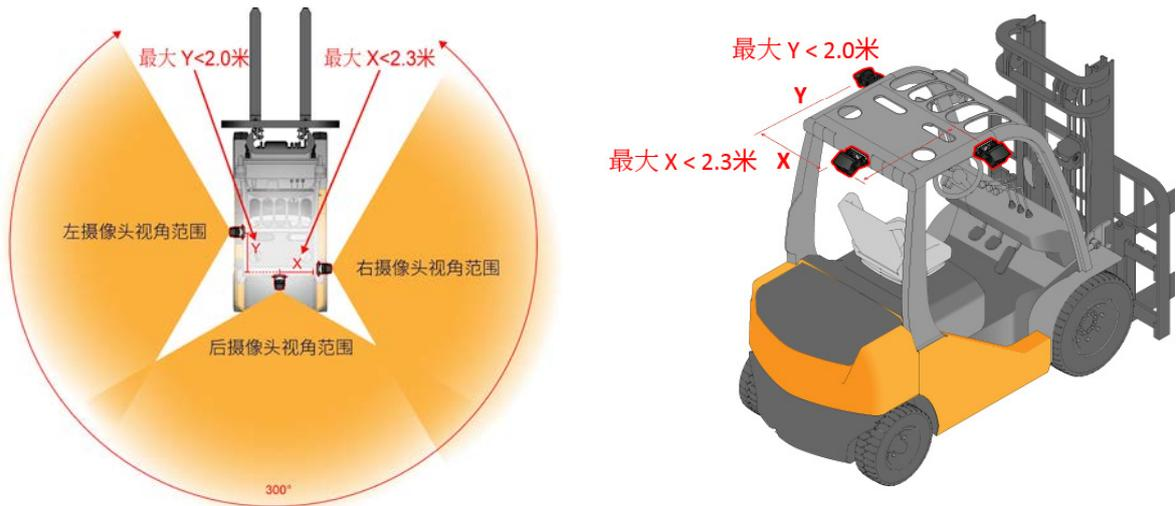
图 19: 情况一摄像头安装示意图
