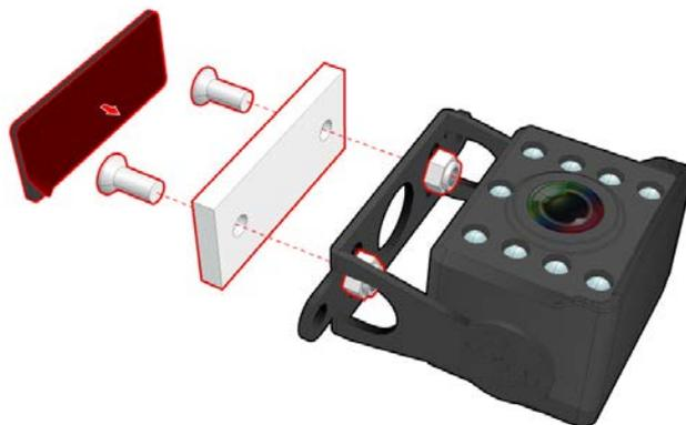
图 12: 安装磁铁及 3M 胶带于前 / 后摄像头支架底部示意图
