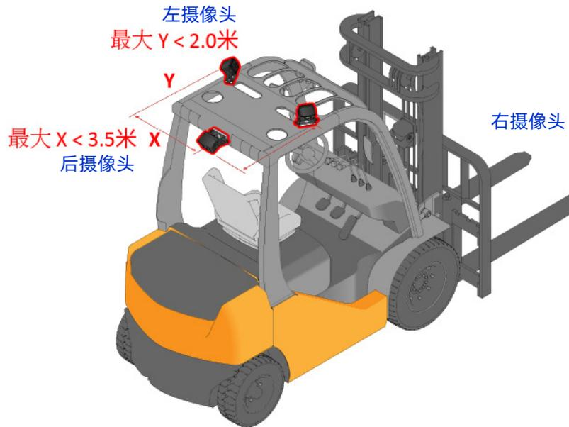
图 18: 摄像头安装位置示意图
