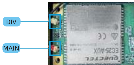
图 50: 将天线连接到 4G LTE miniPCIe 模块
