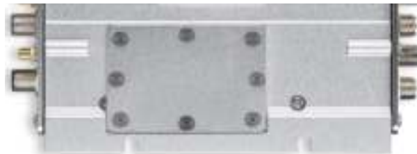
图 55: 更换 4G LTE miniPCIe 模块盒盖
