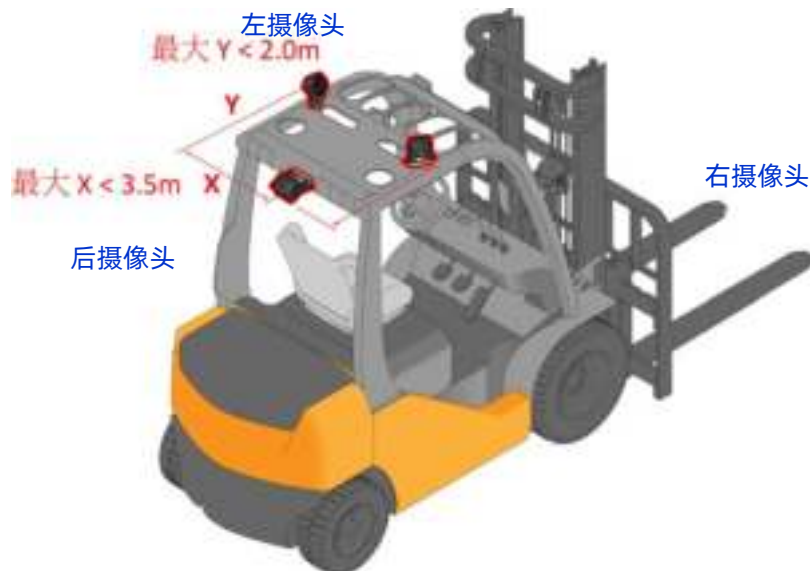
图 13: 摄像头安装位置示意图
