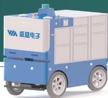
威盛任我行智驾展示套件基于高性能的威盛Mobile360 M800系列车载系统、车规级摄像头、传感器和其它车规级外设，配备先进的开源AI算法，供学生用于其开发项目。所有套件之间的无缝兼容性可以使学生轻松地增强功能并为无限的潜在移动性用例数组定制他们的项目。
