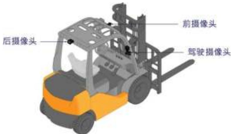
图 12: 摄像头安装位置示意图
