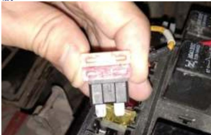
图 29: 拔出的保险丝插入刀片保险丝座电缆上闲置的插槽示意图
