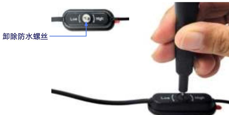
图 52: 拆下倒车灯侦测器灵敏度控制盒上的防水螺丝
