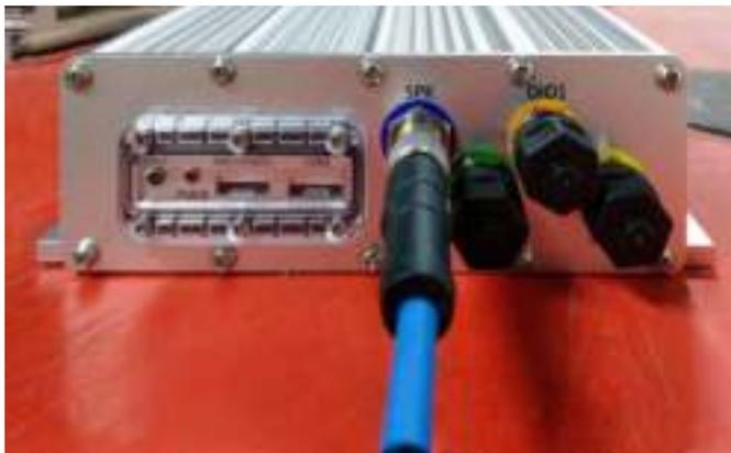
图 21: 喇叭接线安装示意图
