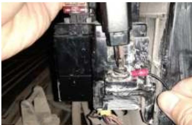
图 32: Y 型接口连接接地线示意图
