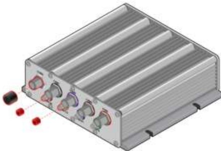
图 08: 安装主机后面板 I/O 防水盖示意图
