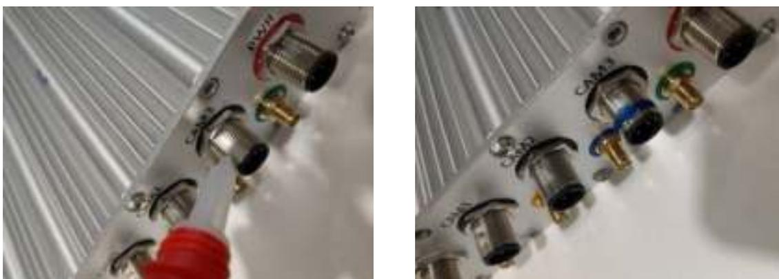
图 20: 电缆接口涂抹螺丝胶（汉高乐泰 243）示意图
