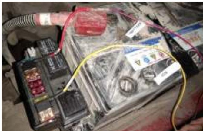
图 31: 刀片式保险丝座电缆插入保险丝盒中的 ACC 保险丝插槽示意图
