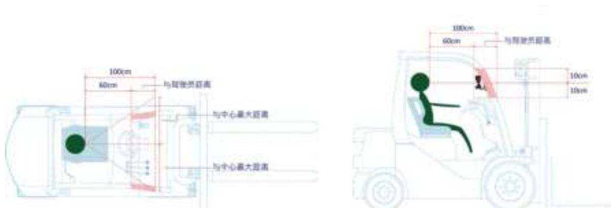
图 17: 驾驶摄像头安装位置建议示意图
