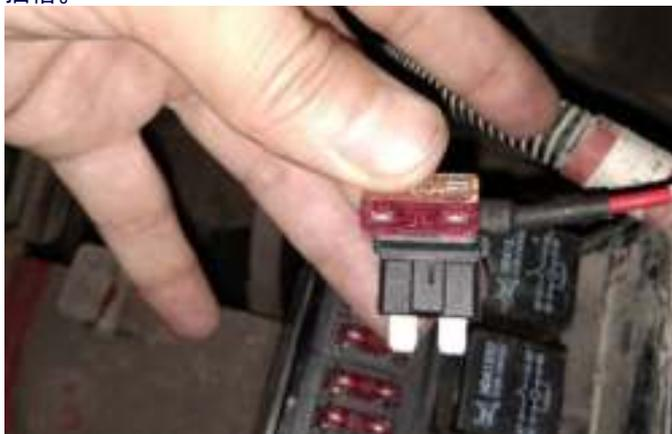
图 26: 插入刀片式保险丝座示意图
