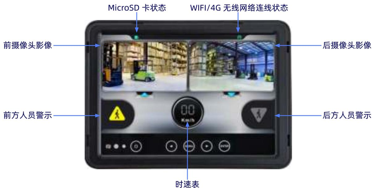
图 54: 无侦测器讯号且与无驾驶摄像头时的显示屏画面
