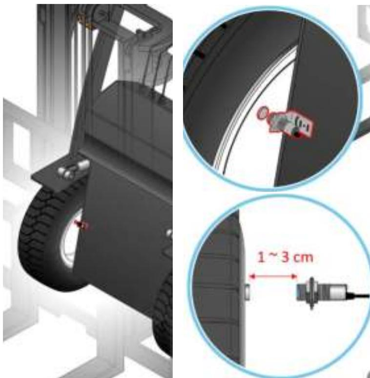
图 49: 安装速度传感器
