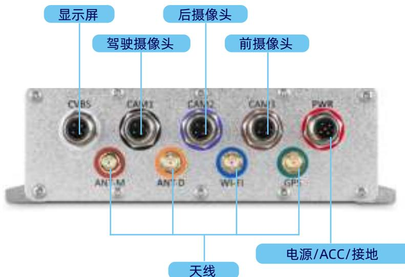
图 02: 后面板 I/O 排列示意图
