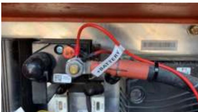
7. 接着寻找叉车上合适的位置安装 VIA Mobile360 直流电源模块。请确认安装的位置能将电源模块的电缆连接至 VIA Mobile360 叉车安全系统主机的红色电源 (PWR) 接头 (电缆共约 2.3 米长)。确认安装位置之后，用马克笔标记两侧螺丝孔的位置并钻孔。
