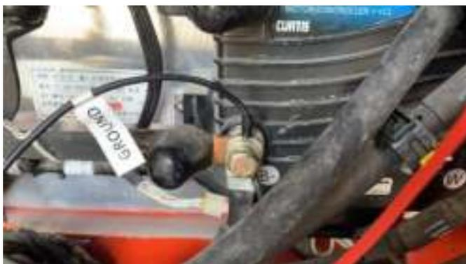
5. 松开步骤 4 找到的回路上的螺栓，将 VIA Mobile360 直流电源模块上黄色电缆末端的 Y 型接头置于螺栓下方，拧紧螺栓以固定电缆。
