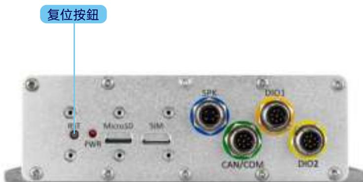
图 34: 主机复位按钮示意图
