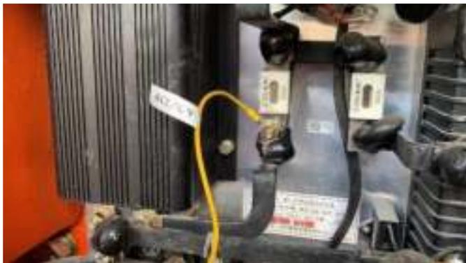
6. 松开步骤 4 找到的电池正极螺栓，将 VIA Mobile360 直流电源模块上红色电缆末端的 Y 型接头置于螺栓下方，拧紧螺栓以固定电缆。将红色电缆和黑色电缆固定妥当之后，此时 VIA Mobile360 直流电源模块电缆接头内部的绿色 LED 应会亮起，代表直流电源模块运作正常。
