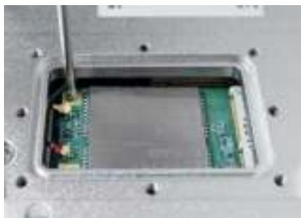
图 63: 保护 4G LTE miniPCIe 模块
